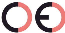
Virheellinen CE-merkki (liian kaukana)
