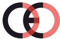
Virheellinen CE-merkki (liian lähellä)
